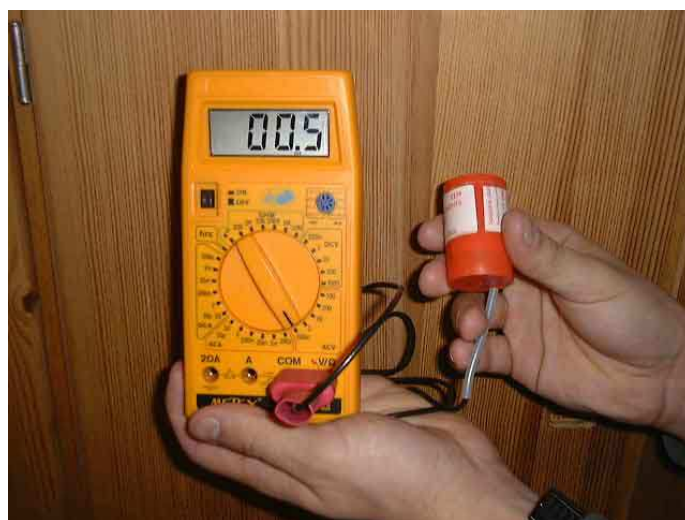
Fig.1: Bobine EFM-140 (montée sur un Multimètre). L'ensemble est destiné à la mesure de champs magnétiques 50 Hz.
