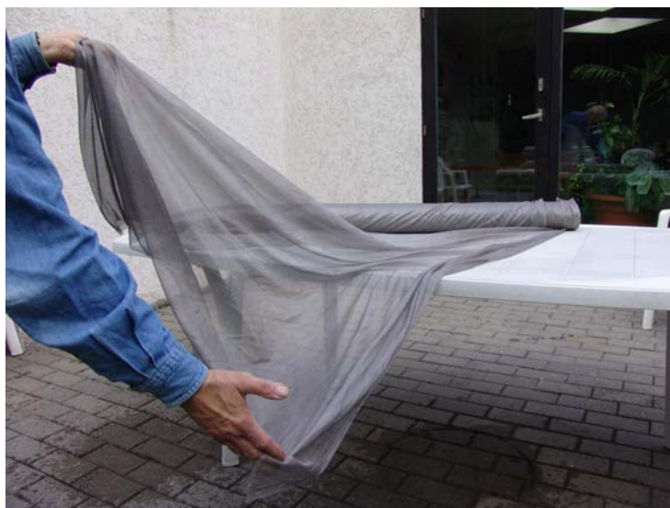
Fig. 12 : Présentation du tissu en polyamide métallisé à l'argent.
