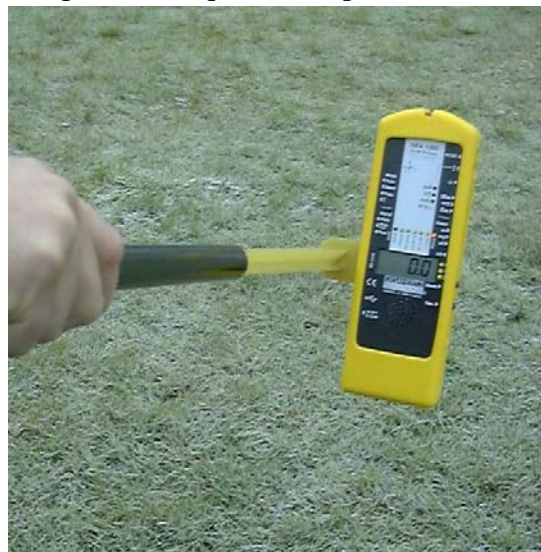
Fig 2 :Appareil de mesure des champs en basses fréquences avec perchette PM4S d'éloignement
