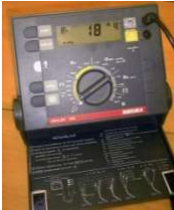
Appareil de mesure de terre et de contrôle de différentiel Norma-Unilap 100 (Autriche)
