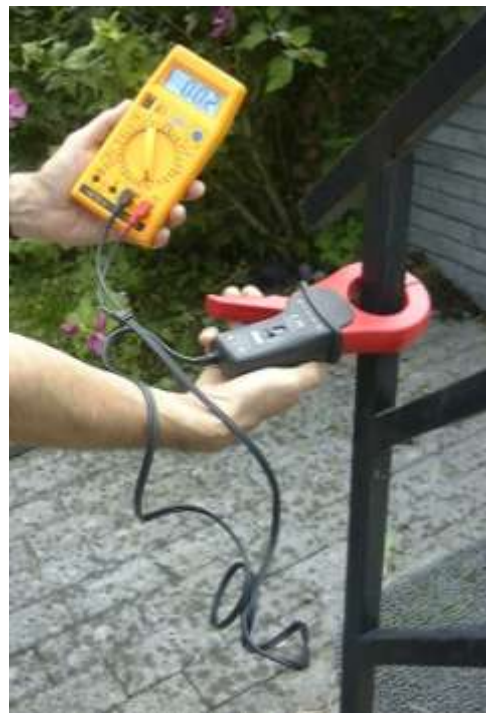
Mesure des courants de fuite (en mA et en mV) sur des armatures métalliques (étables et bâtiments d'élevage) avec pince ampèremétrique couplée à un multimètre
