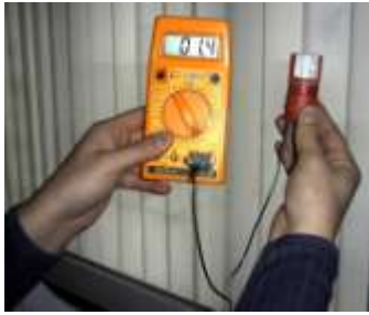
Appareil de mesures EFM-140 (USA) étalonné destiné à la mesure des champs magnétiques 50 Hz
