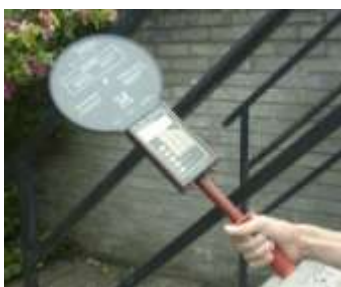
Appareil HOLADAY HI-3604 (USA) destiné à la mesure des champs électriques et magnétiques 50 Hz.
